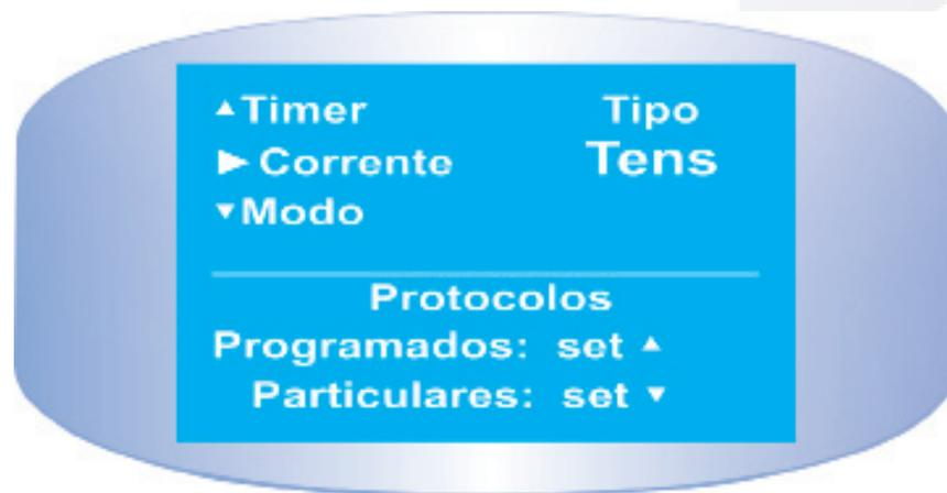
**Figure 11.** Visor para escolha dos protocolos programados e particulares.
